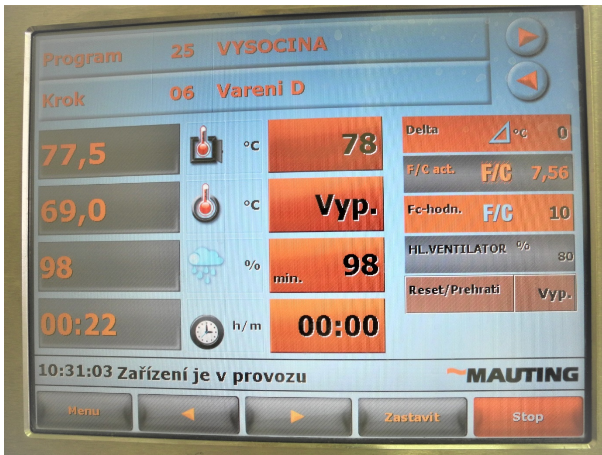
Obr. 4: Řídicí panel udírny Mauting při tepelném opracování salámu vysočina. Z obrázku je zřejmé, že ještě při teplotě v jádře salámu 69 °C byla hodnota Fc realizovaná již ze 75 %.
