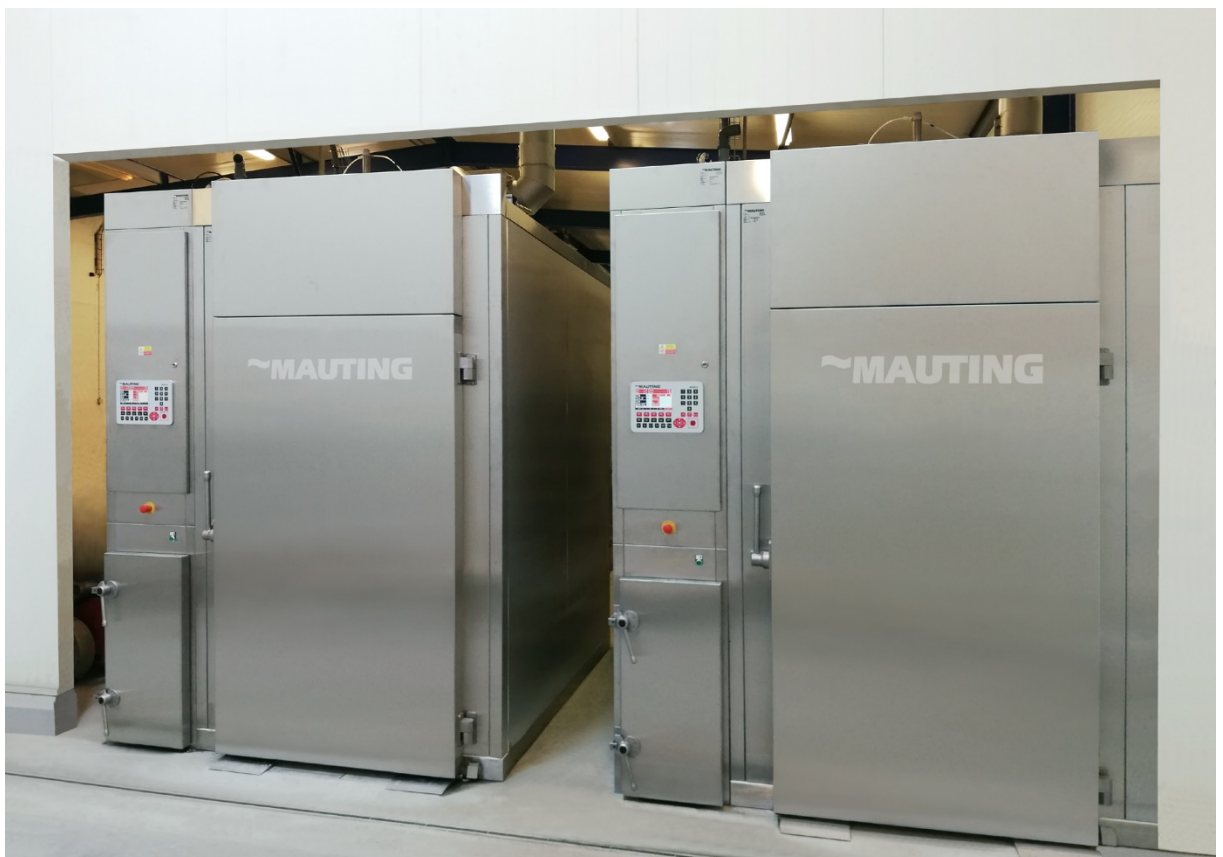
Obr. 1: Moderní udírny Mauting dokáží při tepelném opracování masných výrobků využívat nastavení na hodnotu Fc 70.
